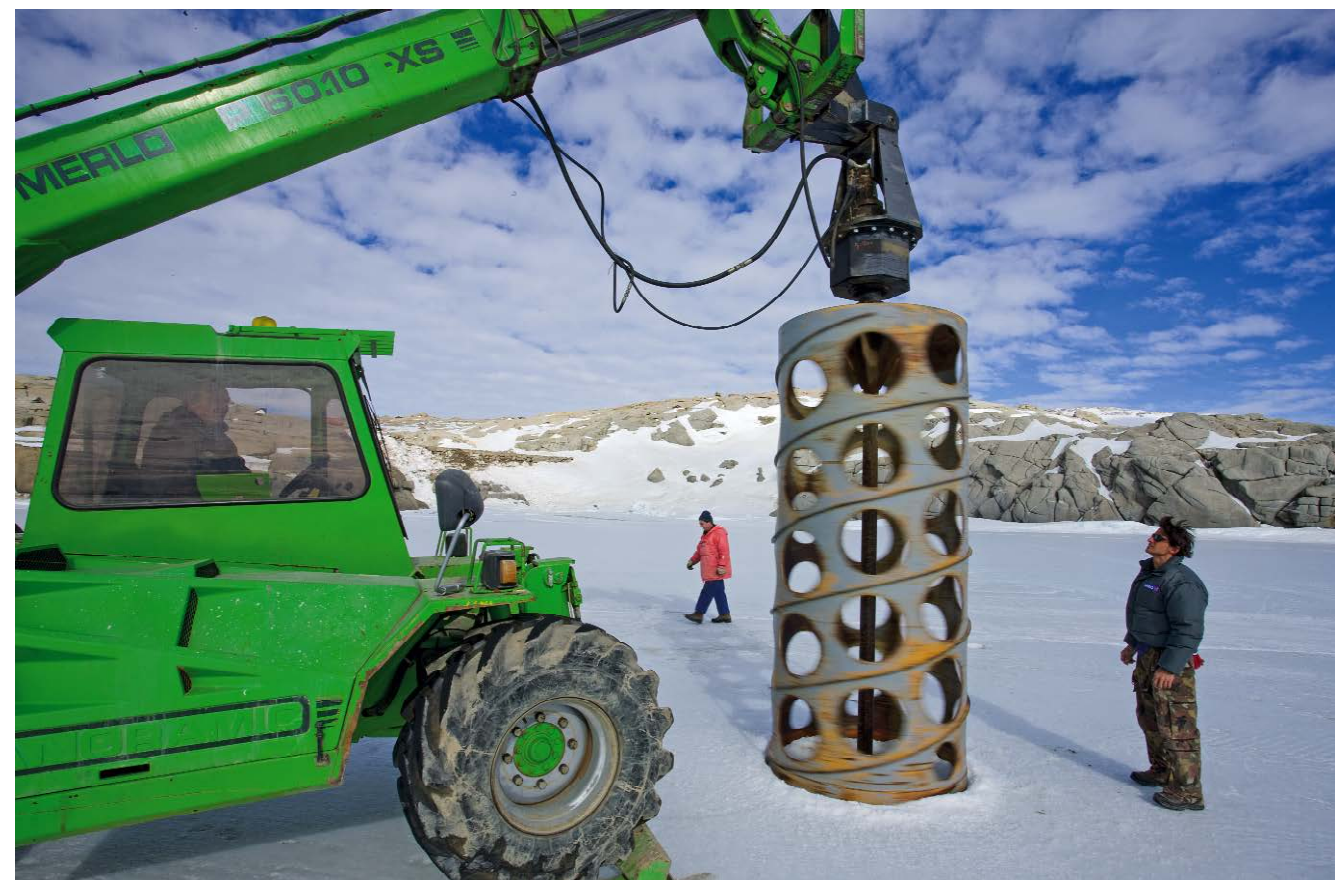
Ricercatori e tecnici del PNRA eseguono un carotaggio del ghiaccio marino nei pressi della base Zucchelli; le carote di ghiaccio verranno analizzate per valutare le popolazioni di alghe microscopiche e definirne il ruolo. Sotto, tecnici del PNRA preparano un foro nel ghiaccio per permettere l'immersione dei sommozzatori. Da qui verranno prelevati campioni di acqua, plancton e pesci.
