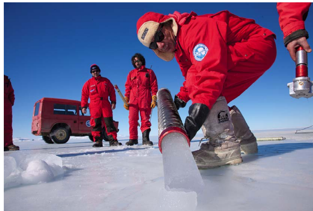
Ricercatori e tecnici del PNRA eseguono un carotaggio del ghiaccio marino nei pressi della base Zucchelli; le carote di ghiaccio verranno analizzate per valutare le popolazioni di alghe microscopiche e definirne il ruolo. Sotto, tecnici del PNRA preparano un foro nel ghiaccio per permettere l'immersione dei sommozzatori. Da qui verranno prelevati campioni di acqua, plancton e pesci.
